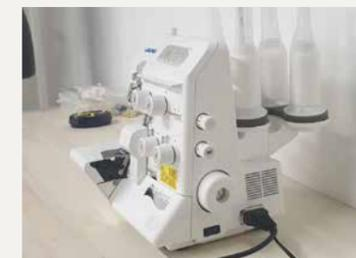
La surjeteuse permet de couper, piquer et surfiler un ou deux tissus en une seule opération. Cela permet à la fois d'assembler des tissus et d'effectuer les finitions. ... Toutefois, elle permet un assemblage plus rapide, sans nécessité de surfilage.
