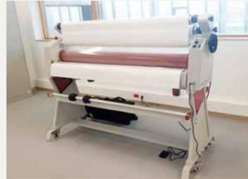
Le laminateur à froid permet de poser une protection plastique sur des supports sensibles à la chaleur tels vinyls.
